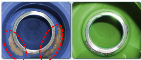
キャビテーション発生によるバルブ損傷例
