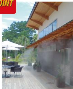
散水前後で室温まで温度が変化。屋根表面温度59.5℃→37.3℃
