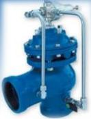
地震や仕切弁開閉時の操作ミスなどで設定圧以上の圧力がかかると、過剰圧を開放し、パイプラインの損傷を防ぎます。
