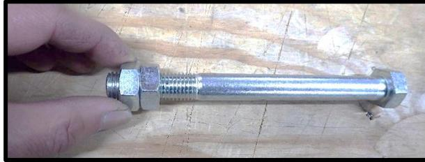
2, 下記写真の様にレンチを挟み、内側を左回し・外側を右回しに共締めします。
