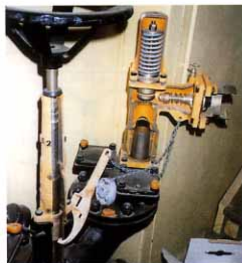
取水管TCRL65の内部構造 (スプリング式リミッター)
